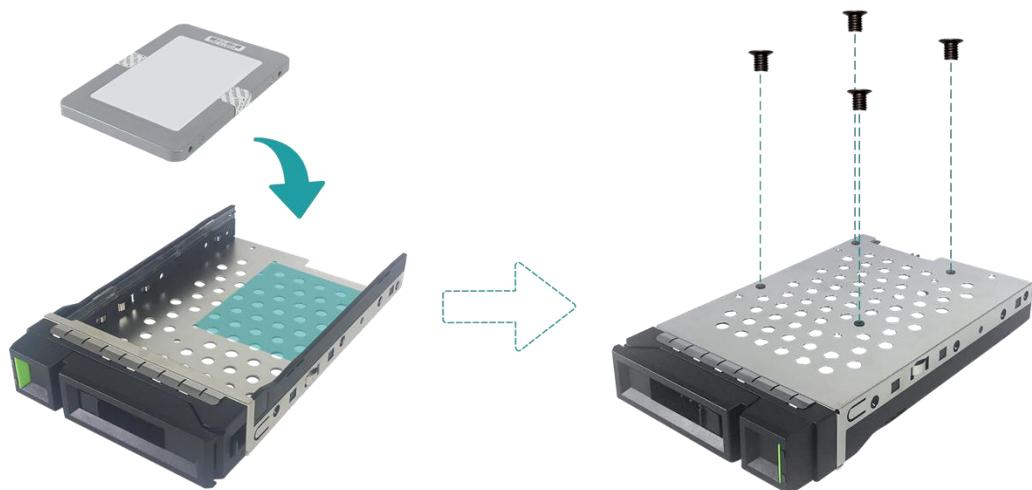
4. 將 LFF 磁碟托盤裝回機器
