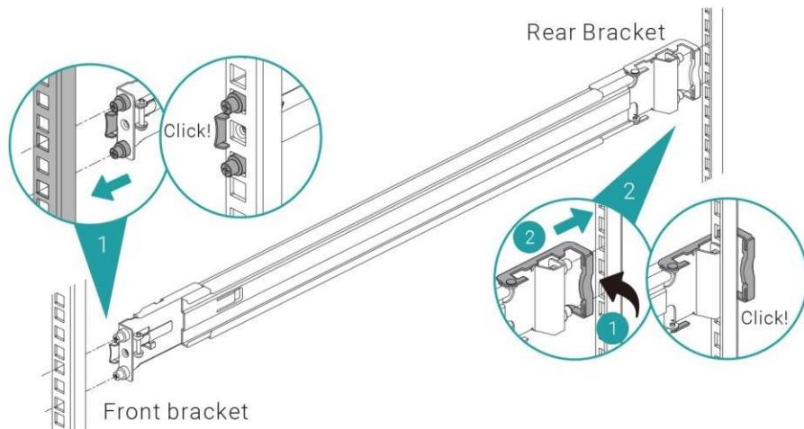
4. 使用两颗M5 螺丝分别将支架固定于两侧导轨中央。(为了确保机器安全，您可以利用额外的四颗M4 螺丝将支架固定于导轨上。)
