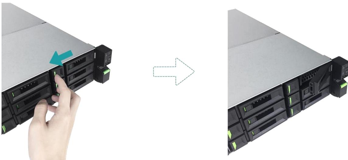
② 握住托架手柄并取出磁盘托架，重复步骤直到抽出所有磁盘托架。
