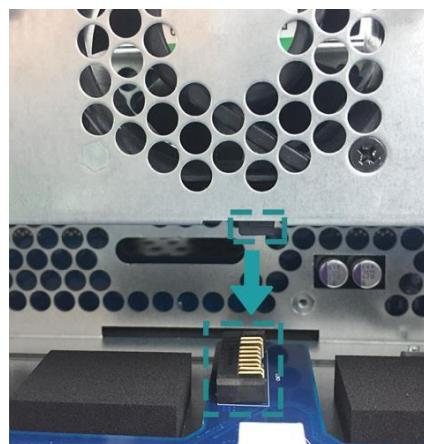
② 请参考下图将风扇模块对齐两旁轨道，平均施力将风扇模块推入至底。
