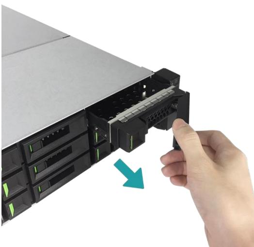
2. 将 3.5 吋磁盘安装于 LFF 磁盘托架
