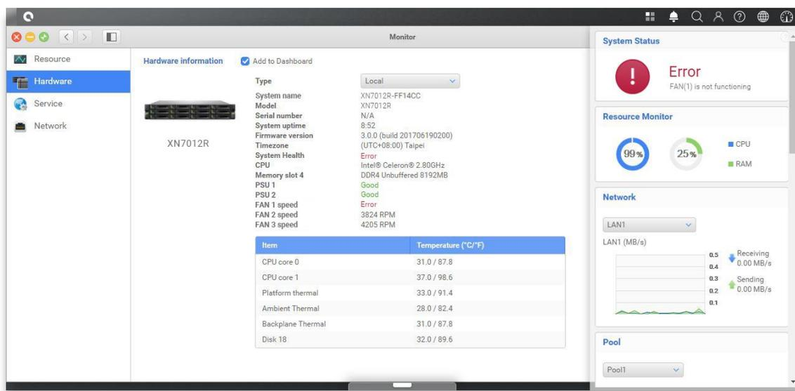
若您看到上述所显示的讯息，代表您需要立即更换风扇模块，请参考[章节 3.4 更换系统风扇](#)进行相关操作。当风扇更换完成后，您可以在 QSM 上面看到该风扇每分钟的转速(RPM) 信息。
