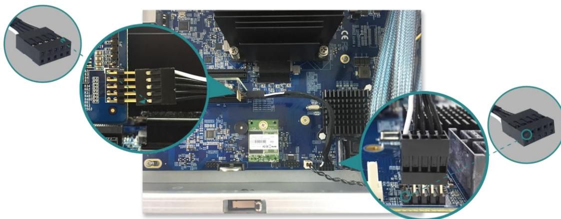
② 将连接线插至连接器上。
