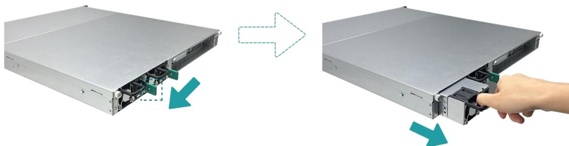
3. 将您准备好的全新电源供应器推入插槽内，直至听到「喀」声。请确认电源供应器的方向是否正确，以防止任何可能的损坏。
