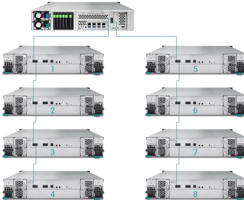
3. 当连接到扩充柜后，您可以至 **QSM → 控制台 → 储存 → 总览 → 扩充柜地图** 检查您的部署拓扑配置。
