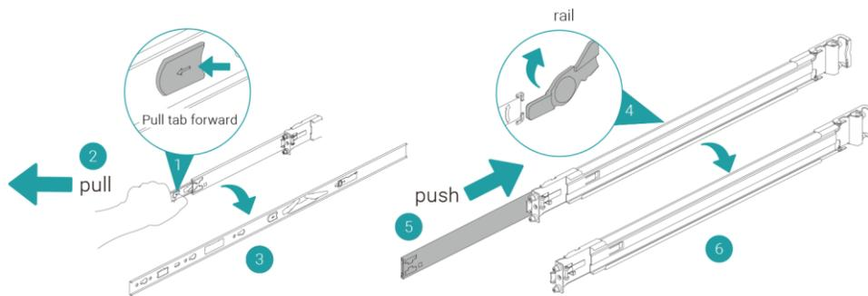
2. 将内侧支架安装于机器两侧。
