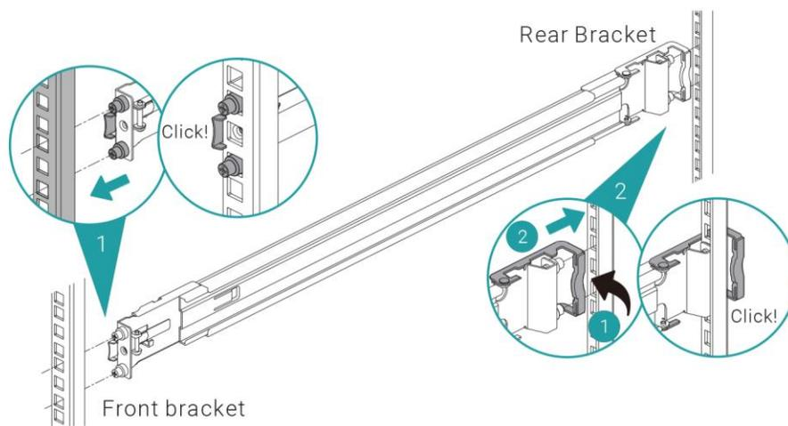
4. 使用两颗 M5 螺丝分别将支架固定于两侧导轨中央。(为了确保机器安全，您可以利用额外的四颗 M4 螺丝将支架固定于导轨上。)
