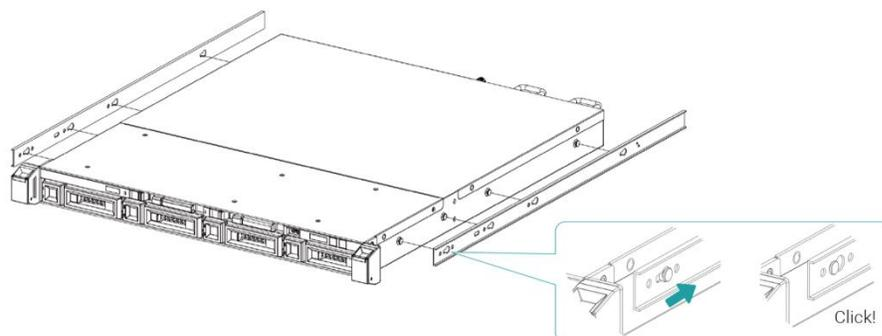
3. 将导轨前端插入机架，并固定后端弹簧片。重复步骤直到安装完左侧及右侧导轨。
