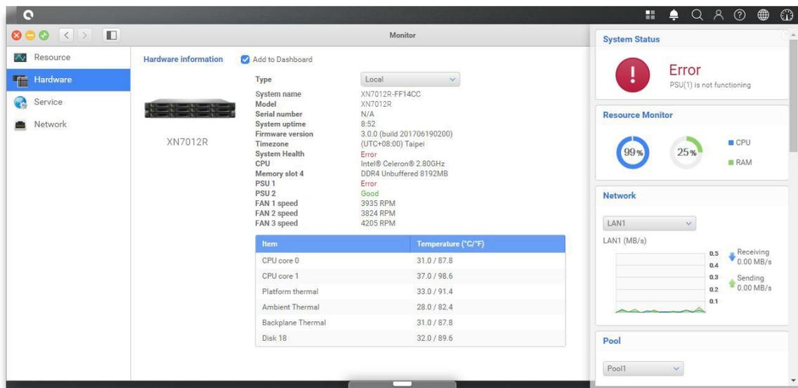
若您看到上述所显示的错误讯息，代表您需要立即更换电源供应器，请参考[章节 3.5 更换电源供应器](#) 进行相关操作。更换完成后，电源供应器指示灯灯号将会自动转为绿色，并且在页面上显示「良好」状态。
