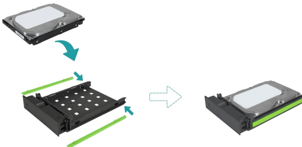
3. 将 2.5 吋磁盘/固态硬盘安装于 LFF 磁盘托架
