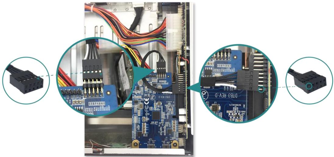
② 将连接线插至连接器上。
