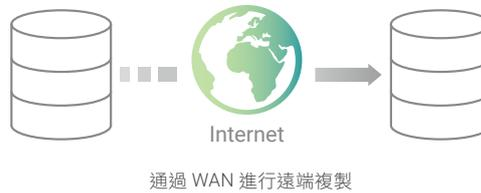
QReplica 2.0 使用 iSCSI 功能設置複製連接。它可以使用指定網路連接埠的全部頻寬讓備份速度達到最佳效果。同時，為了平衡複製流量和非複製頻寬佔用，流量調控功能可以為非複製 I/O 預留必要的頻寬。
