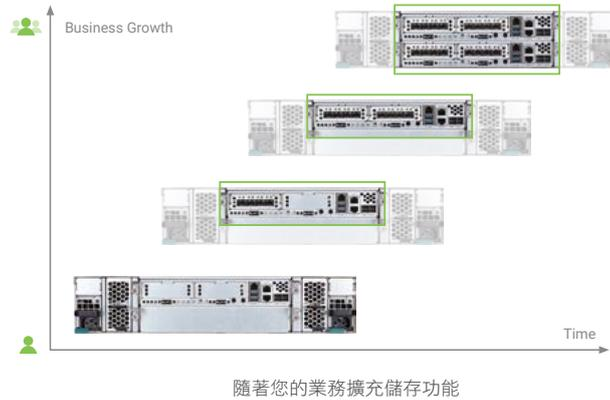
在雙控制器配置中，系統可以支援多達 20 個 10GbE iSCSI 連接埠或 8 個 16Gb 光纖通道連接埠<sup>6</sup>。具有 10GbE SFP+ 和 10GBASE-T 的 iSCSI 介面可以共存並提供資料發送服務。利用這些連接埠，您可以以更符合經濟效益的方式，直接將多台主機伺服器連接到 XS3200 系列，而無需使用光纖通道交換機或乙太網交換機。
