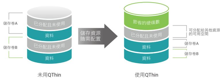
QThin 使用我們的先進儲存池架構來實現此功能，儲存池的容量由儲存池中的所有儲存卷共享。這意味著 XS3200 SAN 能夠使用更少數量的硬碟支援更多的主機伺服器，從而降低初始購置成本。當儲存池滿載時，您可以在不停機的情況下通過添加額外的磁碟組以擴充儲存池容量。
