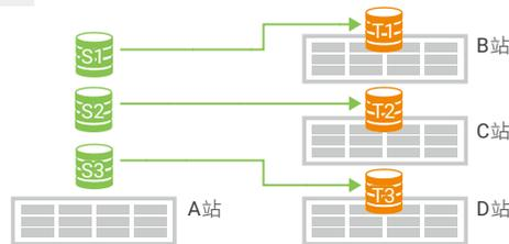
單個SAN儲存系統中的多個來源儲存卷複製到多個SAN儲存系統的多個複製任務。
